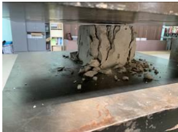
Рис. 6. Процес руйнування зразка
