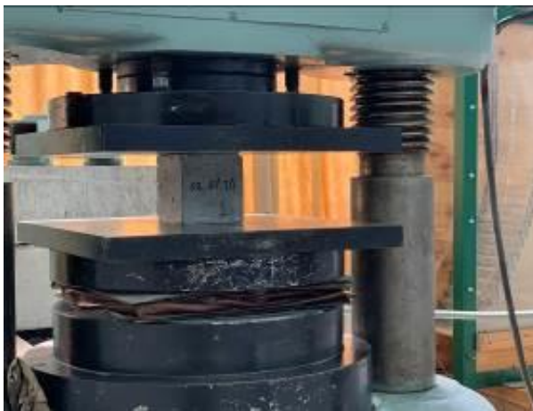
Рис. 4. Підготовка до руйнівних випробувань
